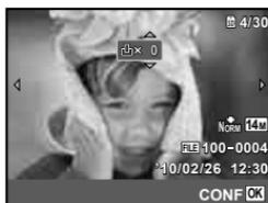
**4** Utilisez  $\triangleleft$   $\triangleright$  pour sélectionner la photo pour la réservation d'impression. Utilisez  $\Delta$   $\nabla$  pour sélectionner la quantité. Appuyez sur la touche [OK].
