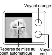
**3** Appuyez doucement sur le déclencheur jusqu'à mi-course. Le voyant vert à droite du viseur s'allume lorsque la mise au point et l'exposition sont mémorisées. A ce stade, vous entendez le bruit du mécanisme de mise au point à l'intérieur de l'appareil, mais aucune photo n'est prise.
