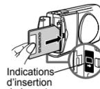
**4** Faites glisser le capot de protection jusqu'à ce qu'il se bloque avec un dé clic.
