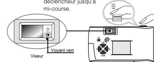
4. Appuyer complètement sur le déclencheur pour prendre la vue.
