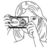
3. Appuyer sur le déclencheur jusqu'à mi-course pour s'assurer que le voyant vert sur la droite du viseur s'allume.
