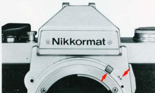
Avec les objectifs à présélection automatique de diaphragme sans index de couplage photométrique interne: affichez la vitesse désirée, puis appuyez sur le bouton de contrôle de la profondeur de champ tout en réglant l'ouverture jusqu'à ce que l'aiguille soit centrée. N'oubliez pas de lâcher le bouton de contrôle de la profondeur de champ avant de déclencher.
