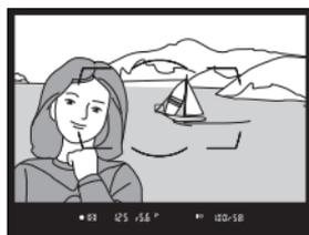
Ne modifiez pas la distance entre l'appareil photo et le sujet pendant la mémorisation de la mise au point. Si le sujet se déplace, effectuez à nouveau la mise au point en fonction de la nouvelle distance.
