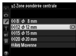
Notez qu'à moins d'avoir sélectionné **Moyenne**, le diamètre est fixé sur 12 mm lorsqu'un objectif sans microprocesseur est utilisé, quel que soit le réglage sélectionné pour **Objectif sans microprocesseur** dans le menu Configuration (☐ 212). Si **Moyenne** est sélectionné, la moyenne de tout le cadre est utilisé que l'objectif soit doté ou non d'un microprocesseur.
