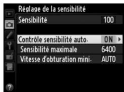
pour la sensibilité ISO est automatiquement réglée sur 100 ISO; à noter que si la valeur sélectionnée pour **Sensibilité maximale** est inférieure à la valeur actuellement sélectionnée pour **Sensibilité**, la valeur sélectionnée pour **Sensibilité maximale** sera utilisée).
