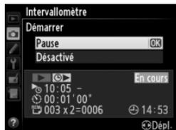
Vous pouvez visualiser les photos et ajuster librement les réglages de prise de vue et de menu lorsque la prise de vues en mode intervallo-mètre est en cours. Le moniteur s'éteint automatiquement environ quatre secondes avant chaque intervalle.
