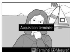
Si l'appareil photo ne parvient pas à mesurer la balance des blancs, le message ci-contre s'affichera. Choisissez une nouvelle cible de balance des blancs et répétez la procédure à partir de l'étape 5.
