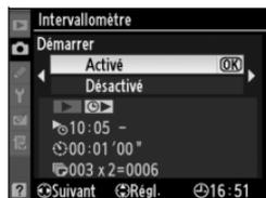
l'intervalloètre, mettez en surbrillance l'option [Démarrer] > [Désactivé] et appuyez sur **OK**). La première série de photographies sera prise à l'heure de démarrage spécifiée. La prise de vue continuera à l'intervalle sélectionné jusqu'à ce que le nombre de photos spécifié soit réalisé.
