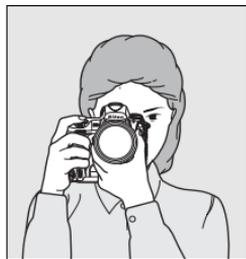
Pour cadrer des photos en format portrait (vertical), déverrouillez le déclencheur pour la prise de vue verticale (p. 5) et tenez l'appareil photo comme illustré ci-contre.
