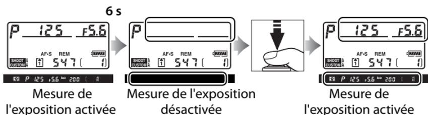
Le délai d'arrêt automatique de la mesure d'exposition peut être réglé à l'aide du réglage personnalisé c2 ([Arrêt mesure auto.], p. 317).
