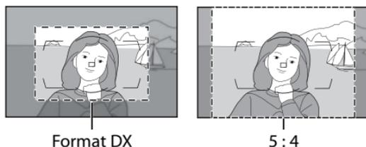
La zone d'image peut être définie à l'aide de l'option [Zone d'image] du menu Prise de vue ou (réglage par défaut) en appuyant sur la commande **Fn** et en faisant pivoter la molette de commande principale.
