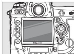
Notez que le miroir se remet en place lorsque l'utilisateur appuie sur l'une ou l'autre commande, ce qui interrompt temporairement le cadrage sur le moniteur. L'option Live view est restaurée lorsque la commande est relâchée. Le point AF peut être sélectionné à l'aide du sélecteur multidirectionnel.
