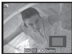
Lorsque vous effectuez un zoom avant sur la vue de l'objectif, une fenêtre de navigation apparaît dans le coin inférieur droit de l'affichage. Utilisez le sélecteur multidirectionnel pour déplacer cette fenêtre dans la délimitation de la zone AF.
