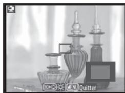
Lorsque vous effectuez un zoom avant sur la vue de l'objectif, une fenêtre de navigation apparaît dans le coin inférieur droit de l'affichage. Utilisez le sélecteur multidirectionnel pour accéder aux zones de la vue non visibles sur le moniteur.
