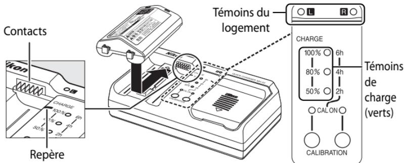
Insérez l'accumulateur (contacts d'abord), en prenant soin de l'aligner sur le repère, puis faites-le glisser dans la direction indiquée jusqu'à ce qu'il s'enclenche. Les témoins de logement et de charge clignotent lorsque l'accumulateur est en charge :
