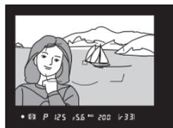
à mi-course, ce qui permet de prendre plusieurs photos successives avec le même réglage de mise au point. La mise au point reste également mémorisée entre les prises de vue tant que la commande **AE-L/AF-L** est maintenue enfoncée.
