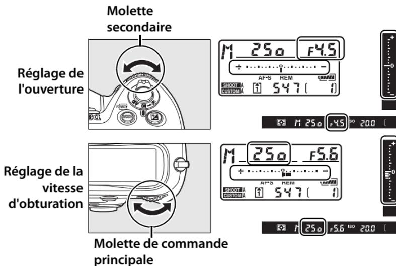
La vitesse d'obturation et l'ouverture peuvent être verrouillées aux valeurs sélectionnées (p. 127, 128).
