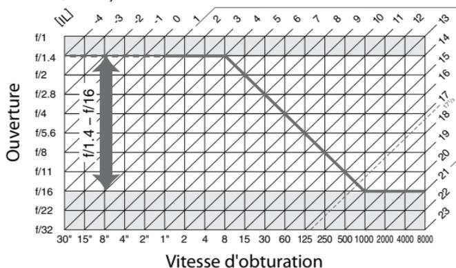
Les valeurs maximales et minimales de l'incrément d'exposition varient en fonction de la sensibilité ISO ; le graphique ci-dessus se base sur une sensibilité équivalente à 200 ISO. En cas d'utilisation de la mesure matricielle, les valeurs supérieures à  $17^{1/3}$  IL sont réduites à  $17^{1/3}$  IL.
