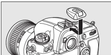
Pour retirer le volet, appuyez dessus avec le pouce et faites le glisser, comme présenté à droite, en maintenant fermement l'appareil photo.
