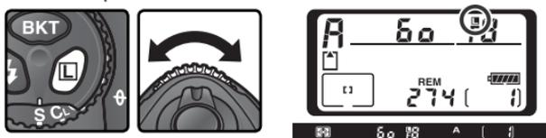
Pour déverrouiller l'ouverture, appuyez sur la commande
