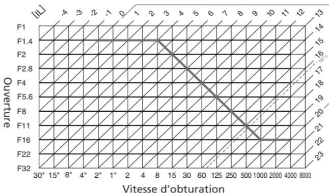
Les valeurs IL maximales et minimales varient avec la sensibilité (équivalence ISO); le graphique ci-dessus est donné pour une sensibilité équivalente à 100 ISO. Avec la mesure matricielle, les valeurs supérieures à 16 2/3 IL sont ramenées à 16 2/3 IL.
