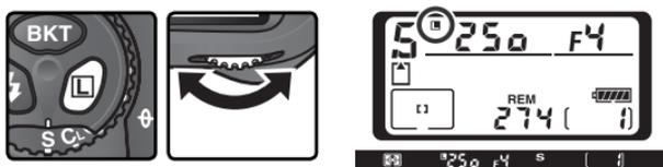
Pour déverrouiller la vitesse d'obturation, appuyez sur la commande
