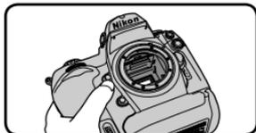
**7** Mettez l'appareil photo hors tension. Le miroir reviendra en position basse et l'obturateur se refermera. Remettez en place l'objectif ou le bouchon d'objectif et débranchez l'adaptateur secteur.
