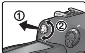
La plage de réglage s'étend de  $-3$  d à  $+1$  d. Des lentilles correctrices (disponibles séparément ; 244) permettent une plage de  $-6$  d à  $+3$  d.
