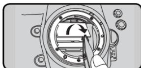
**4** A l'aide des pinces et en le maintenant par l'attache, placez l'autre verre de visée dans le support.
