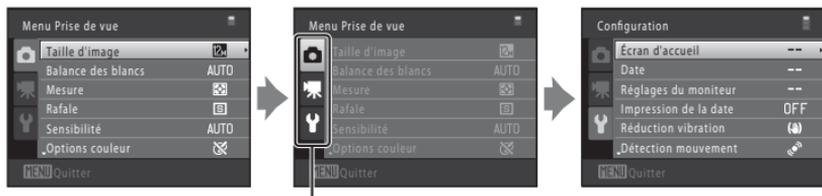
Appuyez sur la commande ◀ du sélecteur multidirectionnel pour mettre l'onglet en surbrillance
