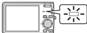
Si le niveau de charge de l'accumulateur est bas après avoir pris une photo avec le flash, le moniteur s'éteint et le témoin du flash va clignoter jusqu'à ce que le flash soit totalement rechargé.
