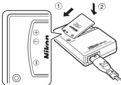
Le témoin CHARGE se met à clignoter lorsque l'accumulateur est inséré ③. La charge est terminée lorsque le témoin cesse de clignoter ④.
