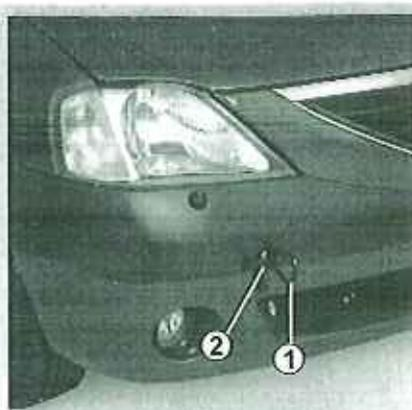
Utilisez exclusivement l'anneau de remorquage 1 (situé dans le coffre) et les points de remorquage avant 2 et arrière 3 (jamais les tubes de transmission). Ces points de remorquage ne peuvent être utilisés qu'en traction : en aucun cas ils ne doivent servir pour soulever directement ou indirectement le véhicule.
