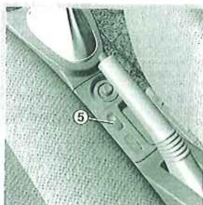
Appuyez sur le contacteur 5 pour condamner le fonctionnement des lève-vitres arrière.
