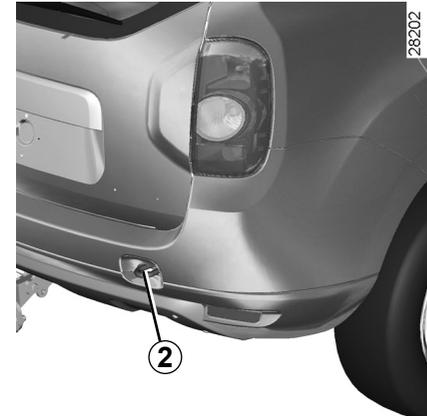
Ces points de remorquage ne peuvent être utilisés qu'en traction, en aucun cas ils ne doivent servir pour soulever directement ou indirectement le véhicule.
