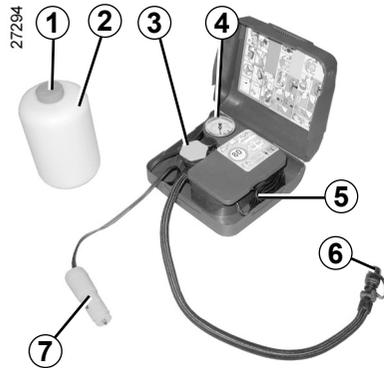
En cas de crevaison, utilisez le kit situé à gauche dans le coffre en version 4x2 ou dans le bac de roue de secours sous le tapis de coffre en version 4x4 : ouvrez le kit, retirez les bouchons **1** et **3** (il est **impératif** de ne pas retirer l'opercule de la bouteille) puis vissez la bouteille **2** sur son support **3**.
