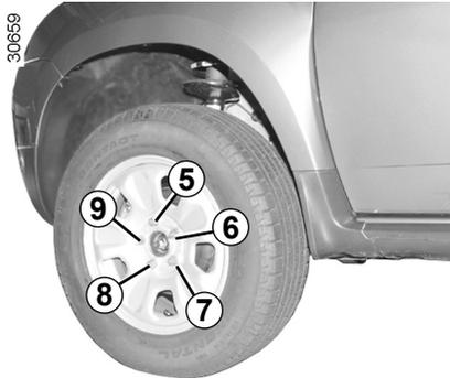
Serrez les vis en vous assurant du bon placage de la roue sur son moyeu et descendez le cric.
