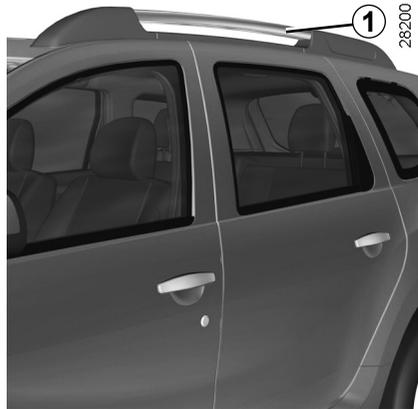
Lorsque le véhicule en est équipé, vous pouvez transporter des bagages ou des accessoires supplémentaires (porte-vélos, porte-skis...) sur une galerie de toit ou sur des barres de toit transversales fixées **1** sur les barres de toit longitudinales ou directement sur celles-ci.
