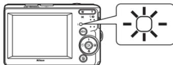
Si le niveau de charge de l'accumulateur est bas, le moniteur s'éteint jusqu'à ce que le flash soit totalement rechargé.
