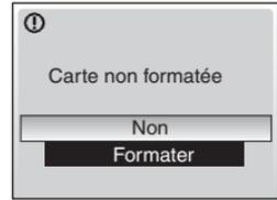
• **Ne mettez pas l'appareil photo hors tension et ne retirez pas les accumulateurs/piles ou la carte mémoire tant que le formatage n'est pas terminé.**
