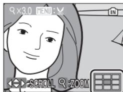
Le guide situé en bas à droite affiche la zone de la photo à élargir. Modifiez la zone de la photo affichée en appuyant sur la commande ▲, ▼, ◀ ou ▶ du sélecteur multidirectionnel.
