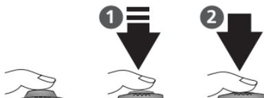
Le COOLPIX5000 est doté d'un *déclencheur* à deux niveaux.
