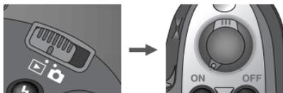
Mettez le sélecteur de mode sur ► et mettez l'appareil sous tension.
