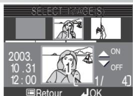
Sélectionnez l'image. L'image sélectionnée sera marquée d'un numéro qui indique sa position dans le diaporama ; appuyez en haut ou en bas du sélecteur multidirectionnel pour changer l'ordre. Pour désélectionner une image, appuyez en bas du sélecteur multidirectionnel jusqu'à ce que le numéro ait disparu.
