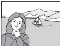
Tout en maintenant le déclencheur légèrement sollicité, recadrez la scène. Ne changez pas la distance entre le sujet et l'appareil photo une fois la mise au point mémorisée. Si votre sujet se déplace, relâchez le déclencheur et refaites la mise au point en tenant compte de la nouvelle distance.
