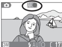
Une fois le déclencheur légèrement sollicité, vérifiez que le témoin lumineux vert (AF) et indicateur de mise au point est bien allumé et ne clignote pas, vous indiquant ainsi que le sujet est mis au point. La mise au point et la mesure de l'exposition resteront mémorisées tant que le déclencheur sera ainsi maintenu.
