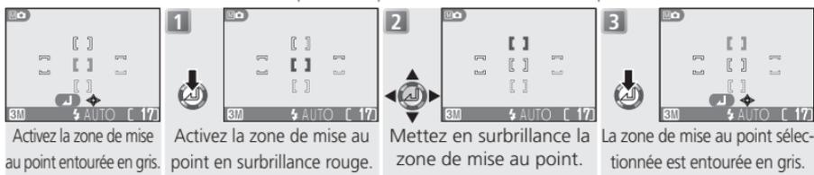
Il n'est pas possible de régler le mode de flash, le mode de déclenchement, le mode macro et la correction d'exposition lorsque la zone de mise au point est en surbrillance rouge. Appuyez au centre du sélecteur multidirectionnel pour sélectionner la zone de mise au point avant de régler ces paramètres.
