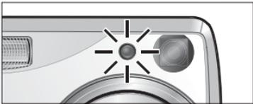
Dès qu'un son est détecté, le témoin du retardateur cesse de clignoter et l'appareil photo fait la mise au point et calcule l'exposition. La photo sera prise une seconde plus tard, même si l'appareil photo n'a pas réussi à obtenir la mise au point.
