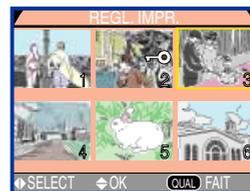
Pressez le joystick vers la gauche ou la droite pour sélectionner l'image désirée. Pour en visualiser davantage, tournez le sélecteur de commande.
