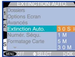
La durée limite de lecture est indépendante de celle des modes [A]-REC et [M]-REC. Elle se règle en sélectionnant l'option **Extinction Auto** dans le menu d'installation lecture. La durée limite des modes [A]-REC et [M]-REC est fixée en sélectionnant **Extinction Auto** dans l'un des menus d'installation [A]-REC ou [M]-REC.
