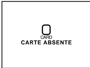
L'appareil ne peut pas détecter de carte mémoire flash. Tournez la molette de sélection jusqu'à la position OFF et vérifiez que la carte mémoire CompactFlash a été correctement insérée dans l'appareil photo comme il est décrit dans la section "Premiers pas : Insertion et retrait de cartes mémoire".
