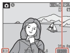
Indicateur du niveau de charge de l'accumulateur
