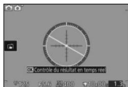
Appareil photo incliné à gauche ou à droite
