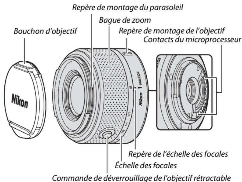
Les objectifs 1 NIKKOR sont destinés exclusivement aux appareils photo numériques Nikon 1 qui acceptent les objectifs interchangeables. Leur angle de champ est équivalent à celui d'un objectif 24x36 mm doté d'une focale environ 2,7 fois plus longue. Ils bénéficient de la fonction de réduction de vibration en mode Normal, mode Actif ou mode Désactivé (📖 143).
