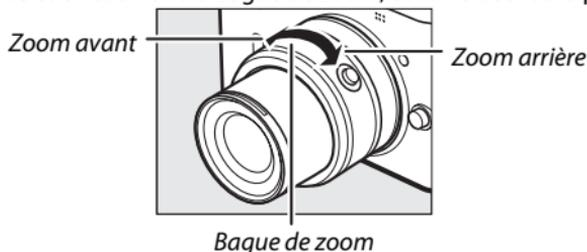
Si vous utilisez un objectif optionnel doté d'un commutateur de zoom motorisé, sélectionnez **T** pour effectuer un zoom avant et **W** pour effectuer un zoom arrière. La vitesse à laquelle l'appareil photo effectue les zooms avant et arrière dépend de la position du commutateur. La position du zoom est indiquée à l'écran par le guide de zoom.
