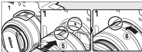
Alignez les repères, plaquez l'objectif sur l'appareil photo, puis faites-le pivoter jusqu'à ce qu'il s'enclenche.
