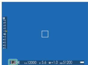
❗ Si le sujet se trouve en dehors de la plage de mesure de l'appareil photo, « -- » s'affiche à la place de la vitesse d'obturation et de l'ouverture.
