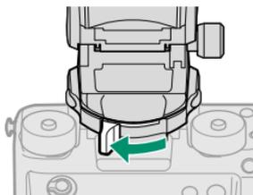
Lorsque le viseur est dans la position souhaitée (①), verrouillez le système de verrouillage du pivotement horizontal (②) pour fixer fermement le viseur.
