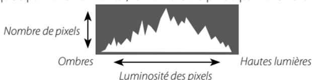
Pour afficher des histogrammes RVB distincts et les zones de l'image surexposées avec les réglages en cours, en superposition de la vue passant par l'objectif, appuyez sur la touche de fonction à laquelle l'option **HISTOGRAMME** est attribuée (📖 162, 182).
