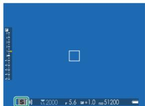
**!** S'il est impossible d'obtenir une exposition correcte avec la vitesse d'obturation sélectionnée, l'ouverture s'affiche en rouge. Si le sujet se trouve en dehors de la plage de mesure de l'appareil photo, « --- » s'affiche à la place de l'ouverture.
