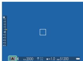
⚠ S'il est impossible d'obtenir une exposition correcte avec l'ouverture sélectionnée, la vitesse d'obturation s'affiche en rouge. Si le sujet se trouve en dehors de la plage de mesure de l'appareil photo, « --- » s'affiche à la place de la vitesse d'obturation.
