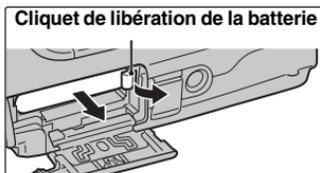
Ouvrez le couvercle du compartiment de la batterie et déverrouillez le cliquet de libération de la batterie avec votre doigt.
