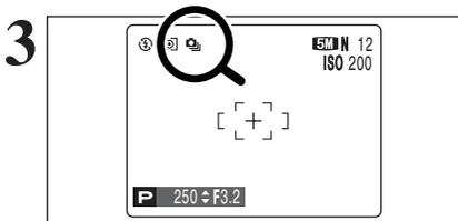
Lorsque vous réglez le mode de prises de vues en continu (sauf sur "OFF"), le mode sélectionné apparaît sur l'écran.
