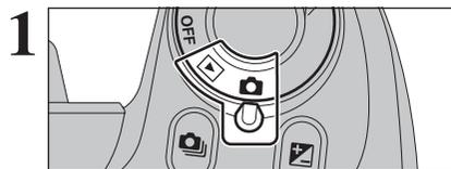
Pour mettre l'appareil photo sous tension, réglez l'interrupteur d'alimentation sur "ON" ou "▶".
