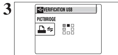
Réglez l'interrupteur d'alimentation sur "ON". "VERIFICATION USB" apparaît ensuite le menu apparaît sur l'écran.
