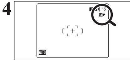
Lorsque le réglage est en mode F-DIAPO ou en mode F-N&B, l'icône apparaît sur l'écran.
