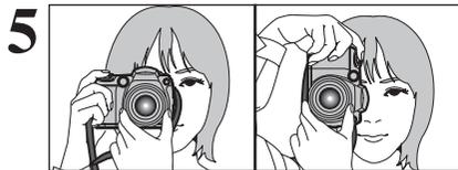
5 Gardez les coudes serrés contre le corps et maintenez l'appareil photo à deux mains. Placez le pouce de la main droite de façon à pouvoir utiliser facilement le zoom.
