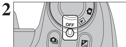
Lorsque le message "L'appareil photo peut maintenant être débranché en toute sécurité" apparaît, cliquez sur le bouton [OK] et débranchez l'appareil photo. Réglez l'interrupteur d'alimentation sur "OFF" pour mettre l'appareil photo hors tension.
