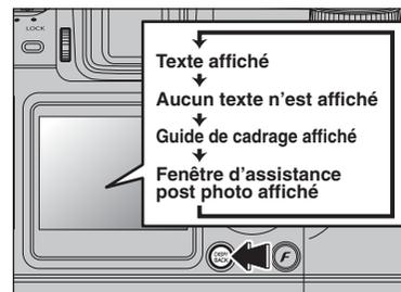
Sélectionnez la fonction de guide de cadrage et la fenêtre d'assistance post photo en mode photographie.
