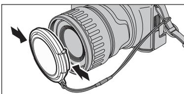
Attachez le bouchon d'objectif en appuyant des deux côtés du bouchon.
