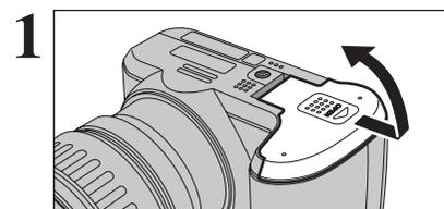
Vérifiez si l'appareil photo est hors tension (réglez l'interrupteur d'alimentation sur "OFF") avant d'ouvrir le couvercle du compartiment piles.
