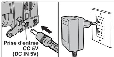
Vérifiez si l'appareil photo est hors tension. Branchez le connecteur de l'adaptateur secteur dans la prise d'entrée CC 5V (DC IN 5V) de l'appareil et branchez ensuite l'adaptateur secteur dans la prise murale.
