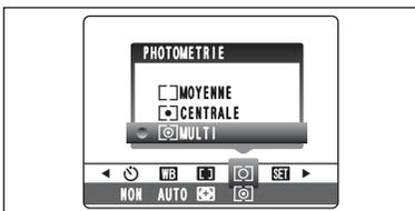
Utilisez ce réglage pour les scènes où la luminosité du sujet et de l'environnement est très différente, et qu'il est par conséquent difficile d'obtenir le résultat désiré avec le réglage MULTI.
