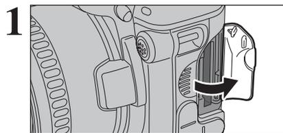
Réglez l'interrupteur d'alimentation sur "OFF", vérifiez si le témoin de l'indicateur est éteint et ouvrez le volet de la fente d'insertion.
