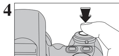
4 Appuyez à mi-course sur le déclencheur (verrouillage AF/AE) sans relâcher la touche, appuyez à fond sur le déclencheur pour prendre la vue.
