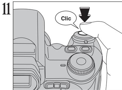
Appuyez à fond sur le déclencheur sans le relâcher. Lorsqu'un déclic est entendu, l'appareil photo enregistre l'image.
