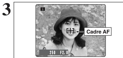
Utilisez le moniteur LCD, cadrez la photo de façon à ce que le sujet remplisse entièrement le cadre AF (Autofocus).
