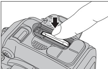
Vérifiez si l'appareil photo est hors tension avant de volet de la fente d'insertion. Il vous suffit d'appuyer légèrement sur la carte **xD-Picture Card** dans la fente puis de retirer lentement votre doigt : la carte se libère et remonte vers l'extérieur.
