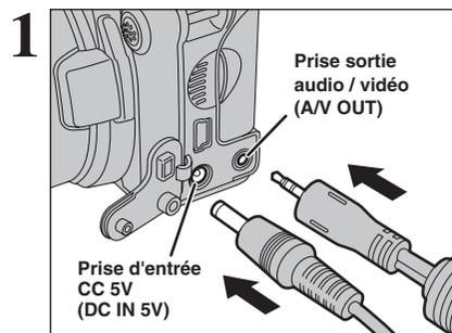
Mettez l'appareil photo et le téléviseur hors tension. Branchez le câble A/V (fourni) dans la prise sortie audio/vidéo (A/V OUT).
