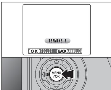
Lorsque l'exposition correcte est mesurée, "TERMINE!" apparaît. Appuyez sur la touche "MENU/OK" pour confirmer le réglage.
