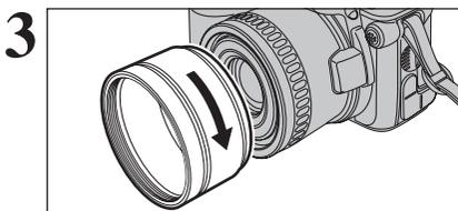
Vissez la bague adaptatrice dans la direction de la flèche pour la monter sur l'appareil photo.
