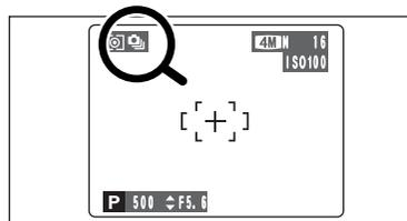
Lorsque vous réglez le mode de prises de vues en continu (sauf sur “OFF”), le mode sélectionné apparaît sur l'écran.
