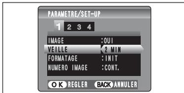
Lorsque cette fonction est activée, l'écran l'appareil photo s'éteint provisoirement et le témoin de l'indicateur (vert) clignote à des intervalles d'une seconde afin de réduire la consommation d'énergie (mode veille) si l'appareil photo n'est pas utilisé pendant 60 secondes. Si l'appareil photo reste inutilisé pendant 2 ou 5 minutes, il se met hors tension. Utilisez cette fonction lorsque vous désirez obtenir la durée d'utilisation maximale de votre batterie.
