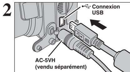
1 Branchez l'appareil photo sur l'imprimante à l'aide du câble USB (mini-B).
