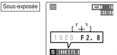
Dans des scènes extrêmement sous-exposées, le réglage d'ouverture (F2,8) apparaît en rouge. Dans ce cas, sélectionnez une vitesse d'obturation plus lente (diminution jusqu'à 3 sec.).
