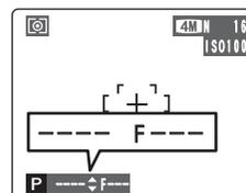
Lorsque la luminosité du sujet est en dehors de plage de mesure de luminosité de l'appareil photo, "..." apparaît sur l'écran en tant que réglage de la vitesse d'obturation et de l'ouverture.
