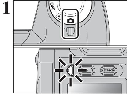
1 Tournez l'interrupteur d'alimentation pour mettre l'appareil photo sous et hors tension. Lorsque vous mettez l'appareil sous tension, le témoin de l'indicateur s'allume en vert.
