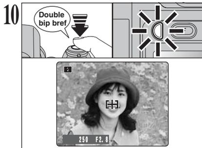
Appuyez à mi-course sur le déclencheur. L'appareil photo émet un bref double bip et effectue la mise au point sur le sujet. Le cadre AF sur l'écran devient plus petit et l'appareil photo règle la vitesse d'obturation et l'ouverture. Le témoin de l'indicateur (vert) s'arrête de clignoter et reste allumé.
