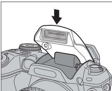
La pression sur le flash fait passer l'appareil photo en mode de flash débrayé.
