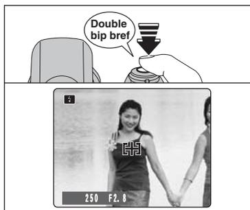
Appuyez à mi-course sur le déclencheur (verrouillage AF/AE). L'appareil photo émet un bref double bip et effectue la mise au point sur le sujet. Le cadre AF sur l'écran devient plus petit et l'appareil photo règle la vitesse d'obturation et l'ouverture. Le témoin de l'indicateur (vert) s'arrête de clignoter et reste allumé.
