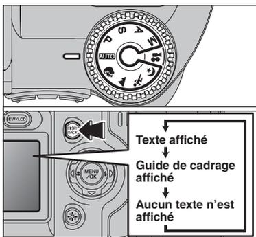
Sélectionner la fonction guide de cadrage en mode photographie. Appuyez sur la touche "DISP/BACK" pour changer l'affichage sur l'écran. Continuez à appuyer sur la touche "DISP/BACK" jusqu'à ce que le "Guide de cadrage" apparaisse.
