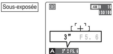
Dans des scènes extrêmement sous-exposées, la vitesse d'obturation apparaît en rouge. Dans ce cas, sélectionnez une ouverture plus petite.
