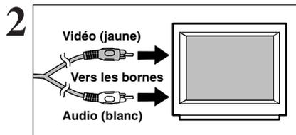
Branchez l'autre extrémité du câble dans la prise d'entrée audio/vidéo (A/V) du téléviseur. Mettez ensuite l'appareil photo et le téléviseur sous tension et procédez à lecture des images comme vous le faites normalement.
