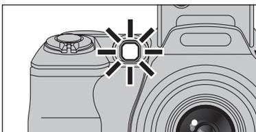
Appuyez à mi-course sur le déclencheur dans des conditions de faible éclairage. L'appareil photo déclenche le témoin d'assistance AF (vert) pour permettre une mise au point plus facile à des distances de prises de vues allant jusqu'à 2 m environ selon le sujet.
