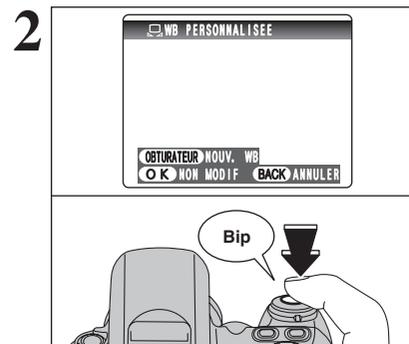
Maintenez une feuille de papier sous la source lumineuse pour régler la balance des blancs de façon à ce qu'elle remplisse l'écran Appuyez sur le déclencheur pour régler la balance des blancs.
