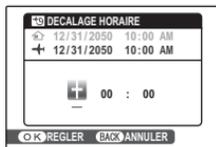
1.3 Appuyez sur la touche de sélection gauche ou droite pour mettre en surbrillance **+**, **-**, les heures ou les minutes ; appuyez sur la touche de sélection supérieure ou inférieure pour éditer. L'incrément minimal est de 15 minutes.
