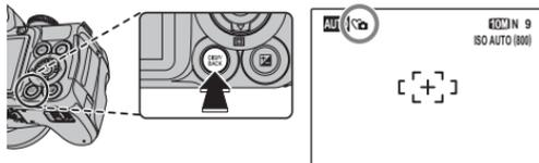
Le haut-parleur de l'appareil photo, l'illuminateur d'assistance de mise au point automatique/le témoin du retardateur s'éteignent et le volume (p. 104) peut être ajusté. Pour restaurer le fonctionnement normal, appuyez sur la touche **DISP/BACK** jusqu'à ce que l'icône
