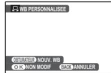
**Si « TERMINE ! » apparaît**, appuyez sur **MENU/OK** pour régler la balance des blancs sur la valeur mesurée. Cette valeur est stockée même lorsque les piles sont retirées et elle peut être sélectionnée de nouveau en appuyant sur **MENU/OK** lorsque les options de balance des blancs personnalisée sont affichées.
