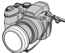
Pour éviter de perdre le capuchon de l'objectif, passez le cordon fourni à travers l'œillet (①) et fixez le capuchon de l'objectif à la dragonne (②).
