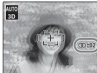
Notez que l'ajustement de la parallaxe réduit la couverture du cadre horizontal. Le nouveau recadrage est indiqué par des bordures noires sur l'affichage.
