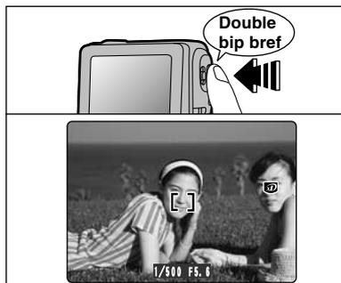
Lorsque vous enfoncez le déclencheur à mi-course, l'appareil photo émet un bref double bip et effectue la mise au point sur le sujet. A ce point, le cadre AF sur l'écran devient plus petit et l'appareil photo règle la vitesse d'obturation et l'ouverture. (Le témoin du indicateur (vert) s'arrête de clignoter et reste allumé.)
