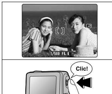
Avec le déclencheur toujours à mi-course (verrouillage AF/AE), déplacez l'appareil photo vers l'image de départ et appuyez à fond sur le déclencheur.
