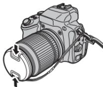
Pour éviter de perdre le capuchon de l'objectif, passez le cordon fourni à travers l'œillet (1) et fixez le capuchon de l'objectif à la courroie (2).
