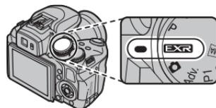
**EXR**: Ce mode optimise la netteté, réduit le bruit, augmente la plage dynamique ou laisse à l'appareil photo le soin de modifier automatiquement les réglages pour qu'ils soient adaptés à la scène (📖 23).
