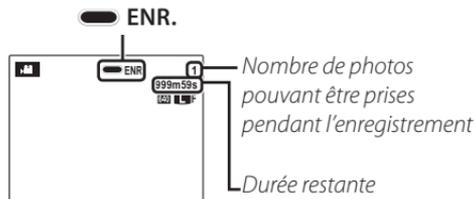
Pour arrêter l'enregistrement, appuyez à nouveau sur la commande ●. L'enregistrement s'arrête automatiquement lorsque la vidéo a atteint sa durée maximale ou lorsque la mémoire est pleine.
