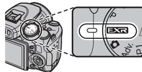
**EXR**: Ce mode optimise la netteté, réduit le bruit, augmente la plage dynamique ou laisse à l'appareil photo le soin de modifier automatiquement les réglages pour qu'ils soient adaptés à la scène (☞ 22).
