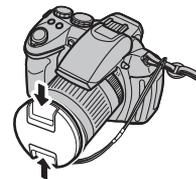
Pour éviter de perdre le capuchon de l'objectif, passez le cordon fourni à travers l'œillet (1) et fixez le capuchon de l'objectif à la dragonne (2).
