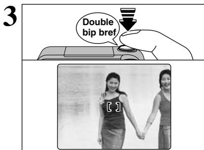
Lorsque vous enfoncez le déclencheur à mi-course, l'appareil photo émet un bref double bip et effectue la mise au point sur le sujet. A ce moment-là, le cadre AF sur le moniteur LCD rétrécit et le réglage de vitesse d'obturation/ouverture apparaît sur le panneau d'affichage (Le témoin du viseur (vert) s'arrête de clignoter et reste allumé).
