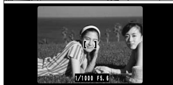
Appuyez à mi-course sur le déclencheur (verrouillage AF/AE). Vérifiez si le cadre AF sur le moniteur LCD rétrécit et si la vitesse d'obturation et le réglage d'ouverture sont affichés (le témoin du viseur (vert) s'arrête de clignoter et reste allumé).
