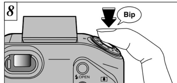
Pour prendre la photo, appuyez à fond sur le déclencheur sans retirer votre doigt. L'appareil photo émet un bip et prend la photo. Les données sont alors enregistrées.
