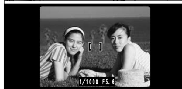
Avec le déclencheur toujours à mi-course (verrouillage AF/AE), déplacez l'appareil photo vers l'image de départ et appuyez à fond sur le déclencheur.
