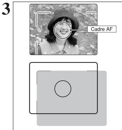
Cadrez la photo de façon à ce que le sujet remplisse entièrement le cadre AF (Autofocus). Lorsqu'une vue est prise à une distance comprise entre 0,6 m et 1,5 m utilisez le viseur, seule la zone ombrée de la figure est photographiée.
