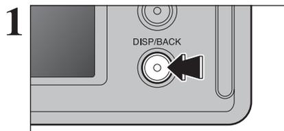
Pour prendre des photos avec le viseur, appuyez sur la touche "DISP/BACK" pour éteindre le moniteur LCD. La mise hors tension du moniteur LCD permet d'économiser de l'énergie.
