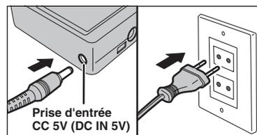
Vérifiez si l'appareil photo est hors tension. Branchez le connecteur de l'adaptateur secteur dans la prise d'entrée CC 5V (DC IN 5V) de l'appareil et branchez ensuite l'adaptateur secteur dans la prise murale.
