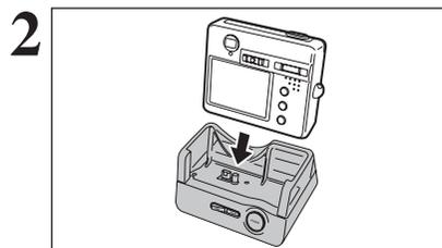
Vérifiez si l'appareil photo est hors tension. Installez l'appareil photo dans la station d'accueil.
