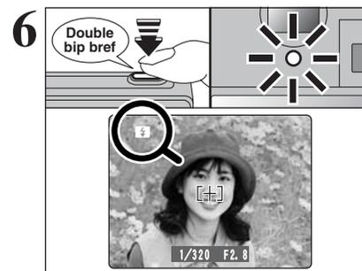
Appuyez à mi-course sur le déclencheur. L'appareil photo émet un bref double bip et effectue la mise au point sur le sujet. Le cadre AF sur le moniteur LCD devient plus petit et le témoin du viseur (vert) s'arrête de clignoter et reste allumé.
