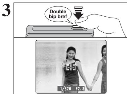
Appuyez à mi-course sur le déclencheur (verrouillage AF/AE). La mise au point est terminée lorsque le cadre AF sur le moniteur LCD se rétrécit et lorsque le témoin du viseur (vert) s'arrête de clignoter et reste allumé.
