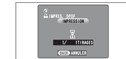
⚠ Appuyez sur la touche "DISP/BACK" pour annuler l'impression. Selon l'imprimante, l'impression peut ne pas être annulée immédiatement ou risque d'être interrompue en cours d'impression. Lorsque l'impression s'interrompt en cours, mettez brièvement l'appareil photo hors tension, puis de nouveau sous tension.
