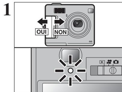
Déplacez l'interrupteur d'alimentation pour mettre l'appareil photo sous et hors tension. Lorsque vous mettez l'appareil sous tension, le témoin du viseur s'allume en vert.
