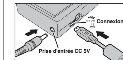
Branchez l'adaptateur secteur, le câble USB ou le câble A/V (fourni) à l'appareil photo directement.
