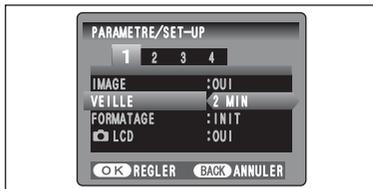
Lorsque cette fonction est activée, le moniteur LCD de l'appareil s'éteint provisoirement et le témoin du viseur (vert) clignote à des intervalles d'une seconde afin de réduire la consommation d'énergie (mode de veille) si l'appareil photo n'est pas utilisé pendant 60 secondes. Si l'appareil photo reste inutilisé pendant 2 ou 5 minutes, il se met hors tension. Utilisez cette fonction lorsque vous désirez obtenir la durée d'utilisation maximum de votre batterie.
