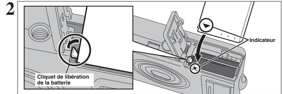
Poussez le cliquet de libération de la batterie sur le côté pour mettre la batterie en place. Vérifiez si la batterie est bien maintenue en place.
