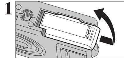
Vérifiez si l'appareil photo est hors tension (témoin du viseur éteint) avant d'ouvrir le couvercle du compartiment batterie.
