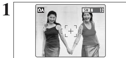
Dans une photo, les sujets (deux personnes dans ce cas) ne sont pas dans le cadre AF. Si la vue est prise à ce moment-là, les sujets ne seront pas mis au point.
