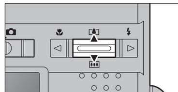
Pour effectuer un zoom avant sur votre sujet, appuyez sur le commutateur zoom "[ZOOM] (▲)". Pour effectuer un zoom arrière, appuyez sur "[ZOOM] (▼)". Le zoom numérique peut être utilisé avec les réglages de qualité de "3M", "2M" et "03M". Lorsque le zoom change d'optique à numérique, l'indicateur "■" sur la barre de zoom s'arrête. Appuyez de nouveau sur le même commutateur zoom pour recommencer à déplacer l'indicateur "■".
