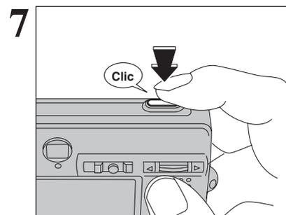
Appuyez à fond sur le déclencheur sans le relâcher. Lorsqu'un déclic est entendu, l'appareil enregistre l'image.
