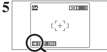
Lorsque le mode photographie est sélectionné avec l'heure mondiale réglée, "←" apparaît sur le moniteur LCD pendant 3 secondes.
