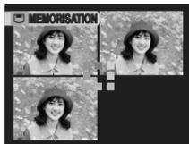
La prise de vue continue aussi longtemps que le déclencheur est maintenu enfoncé. Ce mode photographie jusqu'à 3 images (max. 2,2 images/sec.).
