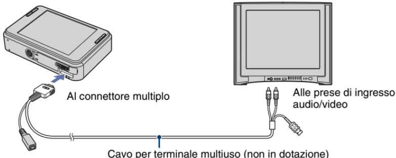
Per vedere su un televisore ad alta definizione, è necessario un cavo per adattatore di uscita HD. Se si riprende con le dimensioni dell'immagine impostate su 16:9, le immagini vengono mostrate su un display a schermo intero.
