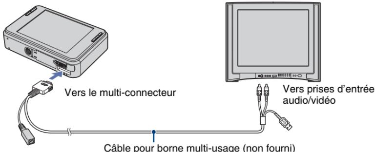
Pour une visualisation sur un téléviseur haute définition, un câble adaptateur de sortie HD est nécessaire. Si la taille d'image est réglée sur 16:9 lors de la prise de vue, les images seront affichées en plein écran.
