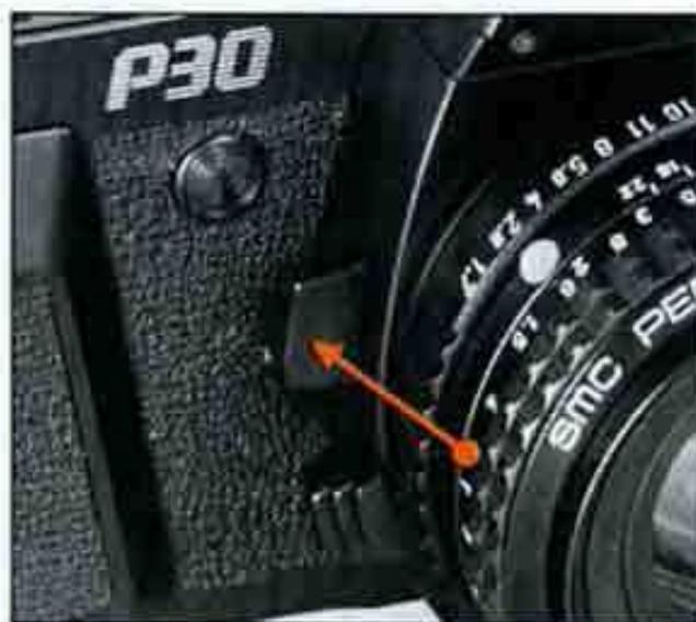
Vous pouvez fermer l'objectif à son ouverture présélectionnée en appuyant sur le levier de contrôle de la profondeur de champ. Vous pouvez alors contrôler la netteté de l'image dans le viseur par observation directe sur le dépoli de tous les éléments de la photo. Après ce contrôle, le diaphragme s'ouvre à nouveau à sa plus grande ouverture dès que vous relâchez la pression sur le levier. Il est impossible de contrôler la profondeur de champ lorsque l'appareil est en mode «programme».
