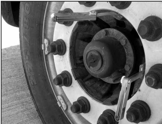
Sur les ensembles de roues à rayons et jante démontables, relâcher puis resserrer les écrous des étriers au niveau de serrage requis. Vérifier à nouveau le voilement de l'ensemble.
