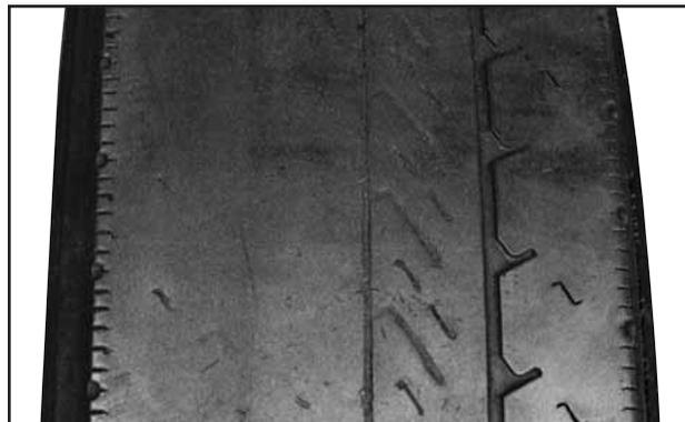
**Usure de carrossage** – Si l'essieu a un angle de carrossage excessif, l'épaule du pneu s'usera par ripage de ce côté. L'usure de carrossage n'est pas perceptible lorsque l'angle de carrossage est de moins de 1 degré.
