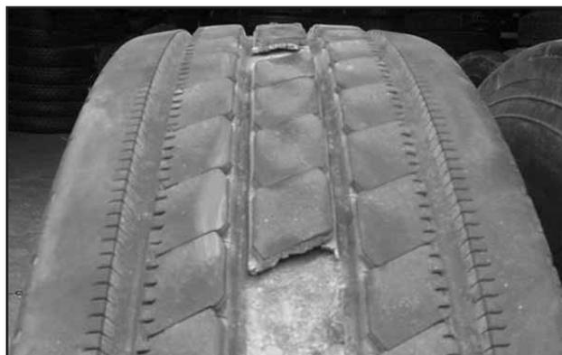
DE SÉRIEUX DOMMAGES dans la partie sommet des pneus radiaux peuvent résulter d'un roulage prolongé sur dynamomètres. Très souvent ces dommages sont internes et ne sont découverts qu'après la remise en service du véhicule.
