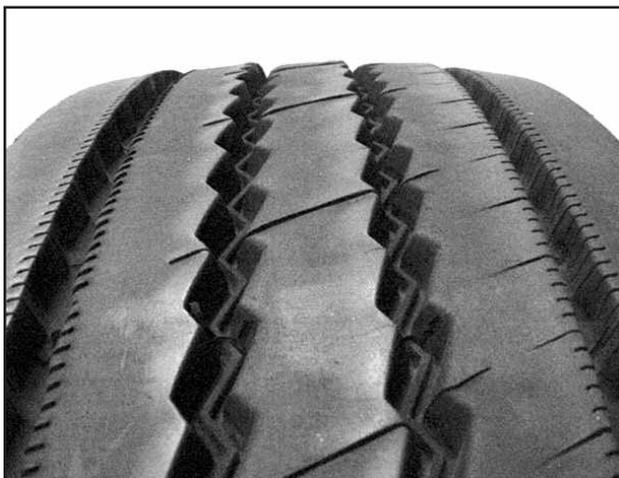
**Ouverture/pincement** – L'usure typique développée suite à une ouverture ou un pincement excessif fait voir un ripage en bavures au travers de la bande de roulement. Une ouverture ou un pincement excessif se retrouve normalement sur les deux pneus de l'essieu de direction.
