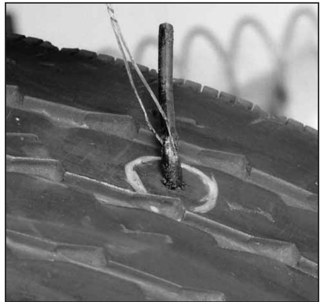
La mèche de caoutchouc obturante sans tête et la combinaison emplâtre/mèche obturante peuvent être insérées de différentes façons. Référez-en aux instructions des fabricants pour bien les utiliser.
