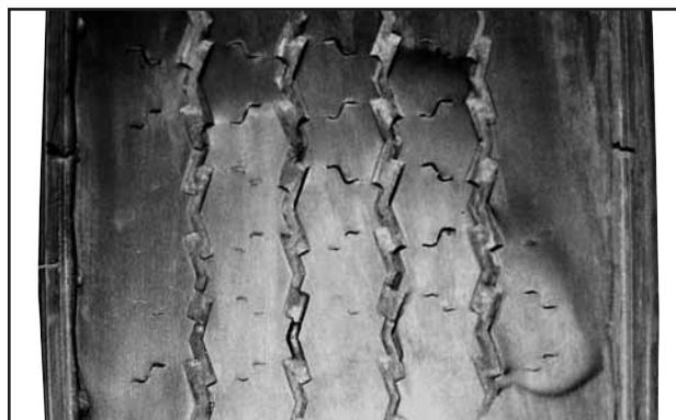
**Usure en patate** – Tout élément constituant la suspension ou la direction d'un camion qui se retrouve lâche ou usé, peut causer une usure bizarre, en bosses et localisée en facettes. Examiner les coussinets de roue lâches, le jeu dans les engrenages de la direction, les embouts de biellette de direction usés et les fusées. Vérifier si le montage pneu/roue est correct
