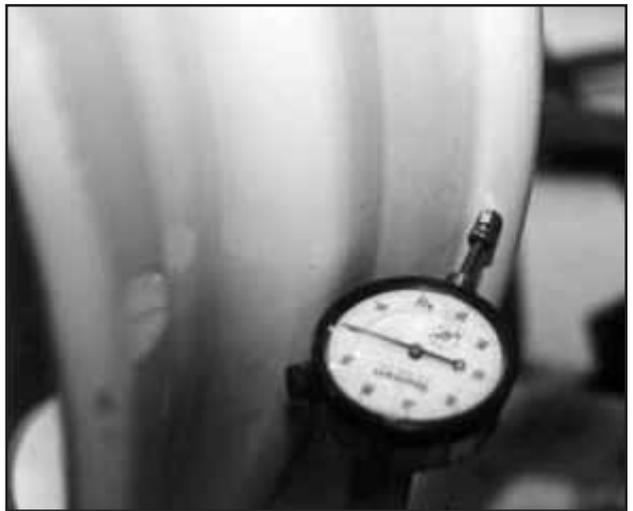
Une vérification du voilement radial (photo du haut) et latéral (photo du bas) de la roue est une autre étape à considérer. Les tolérances du TMC sont de .070 pouces sur une roue à disque tubeless en acier et de .030 pouces sur une roue à disque tubeless en aluminium.
