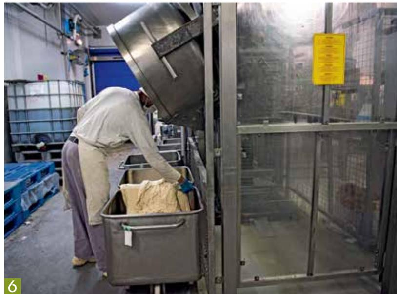
**5 Les opérations** de reprise des charges étaient rencontrées auparavant aux différentes étapes de la ligne de fabrication des baguettes. Si certaines sont encore présentes, comme ici au démoulage, d'autres ont pu être supprimées, à la cuisson et à la scarification.
