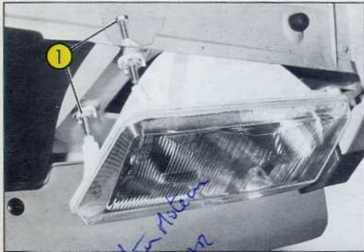
Fig. 9 Réglage des projecteurs 1 - Vis de réglages
