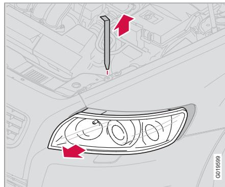
Toutes les ampoules des feux avant (sauf celles des feux antibrouillards) doivent être remplacées en déposant le bloc optique à partir du compartiment moteur.
