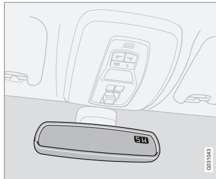
Un écran est intégré dans l'angle supérieur droit du rétroviseur intérieur qui indique la direction de conduite (avant de la voiture). Huit directions différentes sont indiquées avec des abréviations en anglais : **N** (nord), **NE** (nord-est), **E** (est), **SE** (sud-est), **S** (sud), **SW** (sud-ouest), **W** (ouest), **NW** (nord-ouest).
