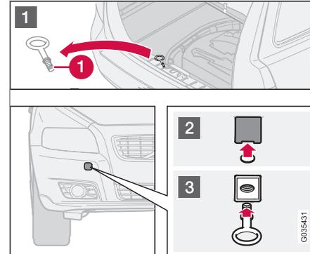
L'œillet de remorquage est fixé dans un orifice fileté situé derrière un cache sur le côté droit du pare-chocs avant ou arrière.
