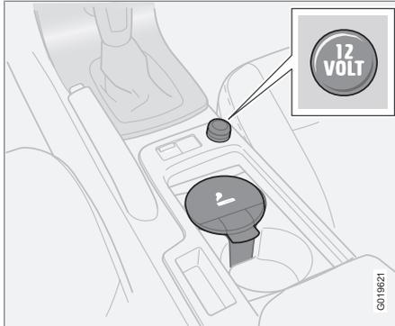
La prise électrique peut être utilisée pour alimenter divers accessoires 12 volts, par exemple un téléphone mobile ou une glacière. La télécommande doit être en position I pour que la prise soit alimentée.
