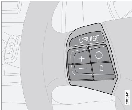
Les commandes du régulateur de vitesse sont placées à gauche sur le volant.
