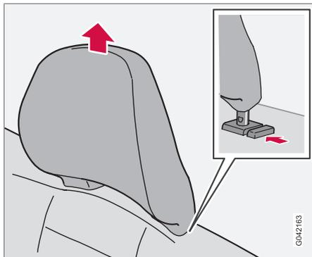
Tous les appuie-tête peuvent être réglés verticalement en fonction de la taille du passager. La partie centrale de l'arrière de la tête doit être au niveau du bord supérieur de l'appuie-tête. Réglez l'appuie-tête selon vos besoins.
