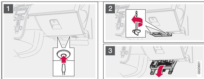
Le boîtier de fusibles contient 50 emplacements de fusible. Les fusibles sont situés sous la boîte à gants. Il existe aussi des emplacements pour les fusibles de rechange. Des outils pour le remplacement des fusibles se trouvent dans le boîtier du compartiment moteur, voir page 241.
