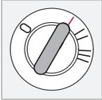
Verrouillage du volant désactivé. Certaines fonctions sont utilisables. Le système électrique du moteur n'est pas activé.
