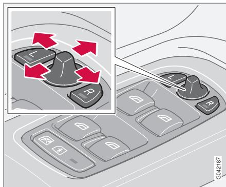
Les commandes pour régler les deux rétroviseurs extérieurs sont placées le plus en avant sur l'accoudoir de la portière du conducteur. Les rétroviseurs peuvent être manœuvrés avec le contact en positions **I** et **II**.
