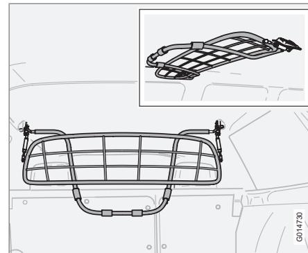
La grille de protection empêche les objets ou les animaux domestiques d'être projetés dans l'habitacle lors d'un freinage brusque. Pour des raisons de sécurité, la grille doit toujours être fixée et arrimée correctement.
