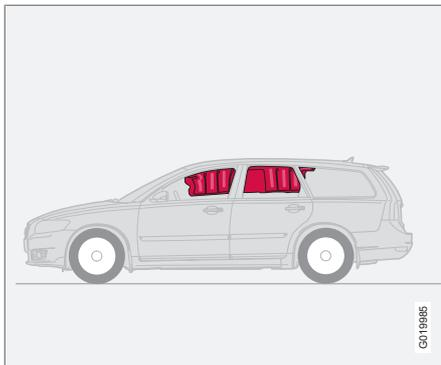
Le rideau gonflable IC (Inflatable Curtain) fait partie des systèmes de coussins gonflables et SIPS. Le rideau gonflable est dissimulé dans la garniture de plafond des deux côtés de la voiture et il protège les occupants des places extérieures. Lors d'une forte collision, les capteurs réagissent et le rideau gonflable se gonfle. Le rideau gonflable a été conçu pour empêcher la tête du conducteur et des passagers de heurter l'intérieur de la voiture en cas de collision.
