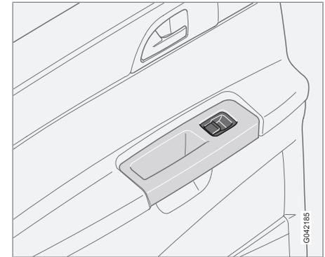
Les vitres des portes arrière peuvent être actionnées à l'aide des commandes de chacune des portes correspondantes ou avec la commande de la porte conducteur. Si le témoin de l'interrupteur de neutralisation des vitres électriques des portes arrière (situé sur le panneau de commandes de la porte conducteur) est allumé, les vitres arrière ne peuvent être commandées qu'à partir de la porte conducteur. Les vitres des portes arrière sont actionnées de la même façon que les vitres des portes avant.
