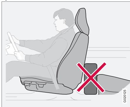
Ne placez jamais d'objets sur le plancher derrière les sièges conducteur et passager qui pourraient gêner le fonctionnement du système WHIPS.
