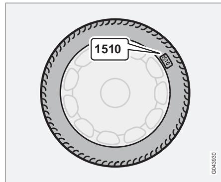
Les pneus ont une durée de vie limitée. Au bout de quelques années, ils commencent à durcir et leur capacité d'adhérence diminue. Dans la mesure du possible, faites monter des pneus de remplacement neufs ayant été stockés le moins longtemps possible. Ceci est particulièrement important pour les pneus d'hiver. Les derniers chiffres indiquent la semaine et l'année de fabrication. Il s'agit du marquage DOT
