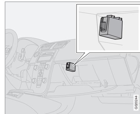
Le téléphone ne peut être utilisé qu'avec une carte SIM valide (Subscriber Identity Module). La carte est délivrée par les différents opérateurs réseau. En cas de problèmes avec la carte SIM, contactez votre opérateur réseau.
