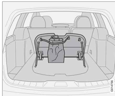
Le dispositif de maintien pour sacs à provision permet de maintenir les sacs en place et évite que leur contenu ne se déverse dans le compartiment à bagages.
