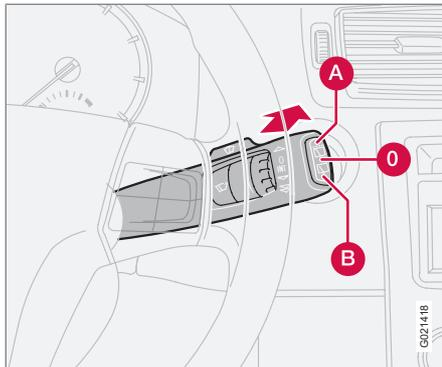
En poussant le levier vers l'avant, l'essuie-glace et le lave-glace de lunette arrière sont activés. L'essuie-glace effectue quelques balayages supplémentaires après la fin du lavage. Le bouton au bout du levier est un interrupteur à trois positions :
