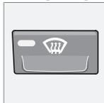
Pour dégivrer et débarrasser rapidement le pare-brise avant et les vitres latérales. Le flux d'air est dirigé sur les vitres en utilisant une vitesse de ventilation élevée. La diode du bouton de dégivrage
