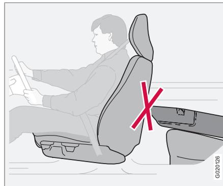
Ne placez jamais d'objets sur la banquette arrière qui pourraient gêner le fonctionnement du système WHIPS.
