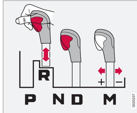
Il est possible de déplacer librement le levier de vitesses d'avant en arrière entre **N** et **D**. Les autres positions sont bloquées par un loquet commandé à l'aide du bouton de blocage du sélecteur de vitesses.
