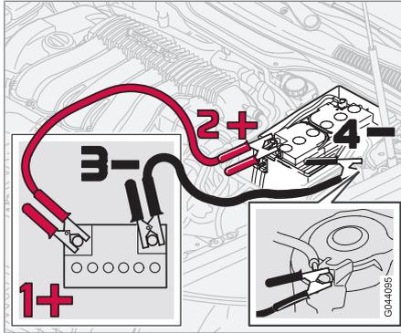
Si la batterie de la voiture est déchargée, il est possible de se servir d'une batterie auxiliaire ou d'un autre véhicule. Veillez toujours à ce que les pinces du câble de démarrage soient bien serrées pour éviter la production d'étincelles lors d'une tentative de démarrage.
