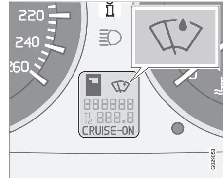
Le capteur de pluie détecte la quantité d'eau sur le pare-brise pour activer automatiquement les essuie-glace. La sensibilité du capteur de pluie peut être réglée avec la molette (C), voir page 66.
