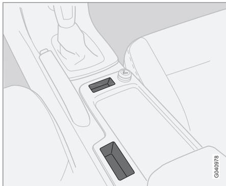
Lorsqu'il n'y a pas de boutons pour l'aide au stationnement et BLIS, voir pages 170 et 172, l'espace peut être utilisé pour le rangement.
