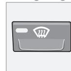
Pour dégivrer et débarrasser rapidement le pare-brise avant et les vitres latérales. Le flux d'air est dirigé sur les vitres en utilisant une vitesse de ventilation élevée. La diode du bouton de dégivrage s'allume lorsque la fonction est connectée.
