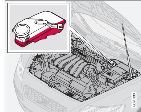
Les liquides de frein et d'embrayage ont le même réservoir<sup>3</sup>. Le niveau doit se trouver entre les repères **MIN** et **MAX** de la jauge. Vérifiez le niveau régulièrement. Remplacez le
