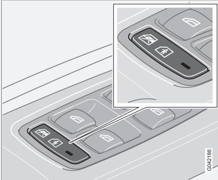
Neutralisation des lève-vitres électriques arrière et verrouillage de sécurité enfant électrique\*.
