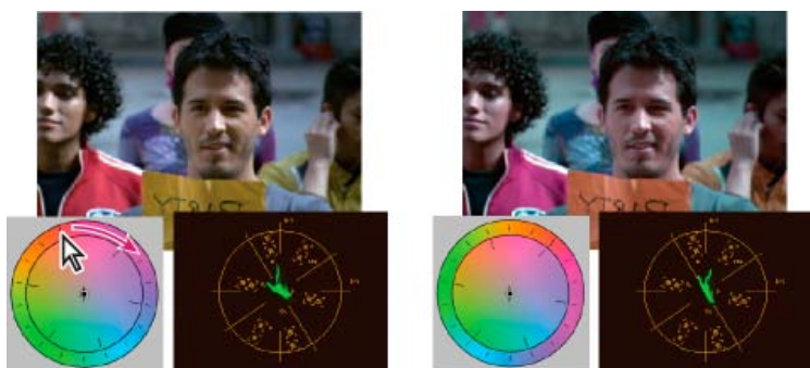
Faire pivoter le cercle extérieur de la roue chromatique (gauche) modifie l'angle de la teinte (droite).
