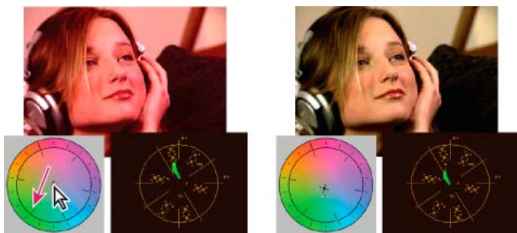
Réglage du gain de la balance pour peaufiner l'amplitude de la balance.
