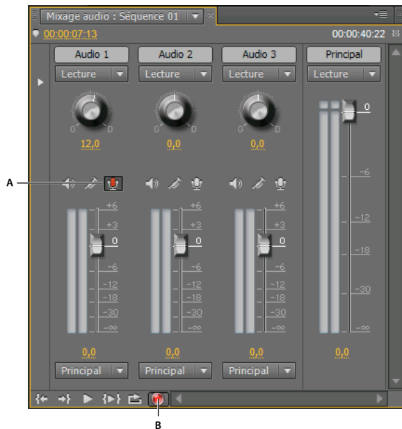
Commandes d'enregistrement du panneau Mixage audio A. Bouton Activer la piste pour l'enregistrement B. Bouton Enregistrer
