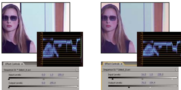
Image originale (gauche) ; noirs et blancs corrigés pour répondre aux limites de la télédiffusion (droite)
