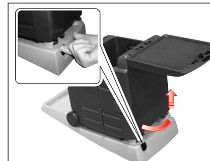
3. Ouvrez le couvercle à l'arrière du bas du plateau. Pour dégager le verrou du côté gauche, faites tourner le plateau dans le sens de la flèche tout en pressant le bouton de verrou intérieur. Retirez l'ensemble du plateau.
