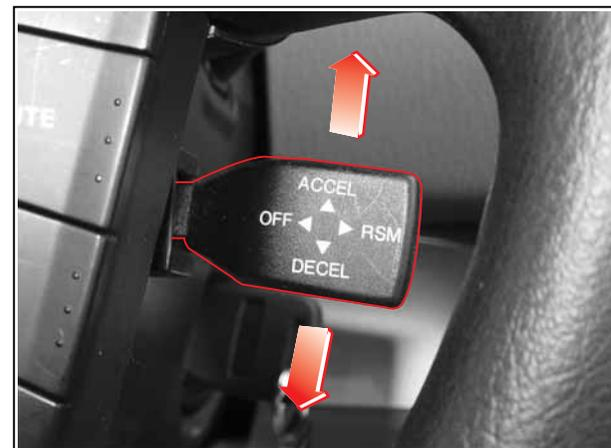
1. Pour actionner la régulation de vitesse, accélérez jusqu'à la vitesse désirée au moyen de la pédale d'accélération, à plus de 36 km/h.
