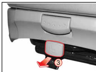
Pour diriger le siège de seconde rangée vers l'arrière, levez le levier ③ et faites tourner le siège jusqu'au dé clic.
