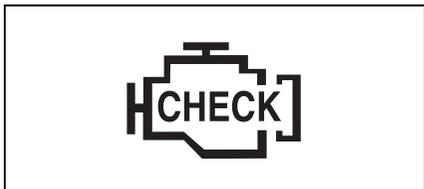
Ce témoin s'allume quand le contact est mis et s'éteint si le moteur fonctionne normalement.
