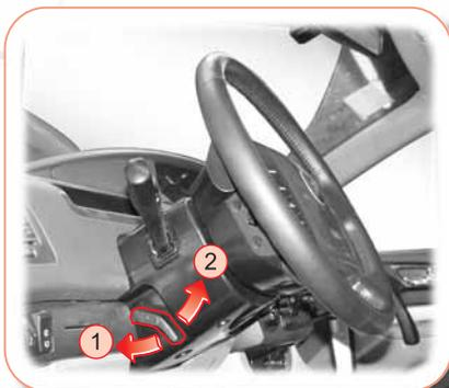
Le volant peut être réglé verticalement à la position désirée. Déplacez le levier de commande dans le sens de la flèche ① et réglez le volant vers le haut ou vers le bas à la bonne position. Pour verrouiller le volant à cette position, déplacez le levier dans le sens de la flèche ②.
