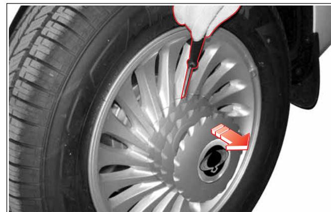
6. Retirez le chapeau de roue au moyen d'un tournevis à lame plate.
