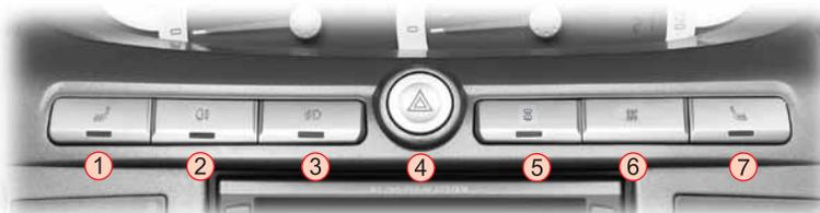
1. Commutateur de chauffage de siège (siège du conducteur)
