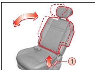
Pour modifier l'angle du dossier de siège, penchez-vous en avant légèrement et levez le levier ①. Ensuite, penchez-vous vers l'arrière à l'angle désiré et relâchez le levier. Ce levier est conçu pour régler le dossier de siège jusqu'à un certain angle.
