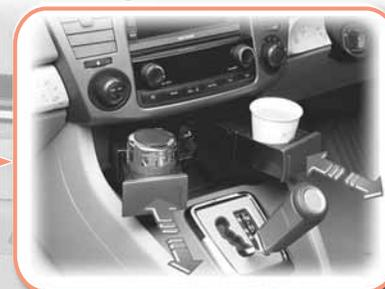
En appuyant sur l'avant du cache, le porte-gobelet s'ouvre. Pour le fermer, poussez-le jusqu'au déclic.
