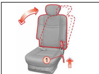
Pour changer l'inclinaison du dossier, penchez-le légèrement en avant et soulevez le levier. Penchez le ensuite en arrière jusqu'à la position désirée et relâchez le levier. Ce levier est conçu pour relever le dossier jusqu'à un certain angle et pour l'abaisser à plat.
