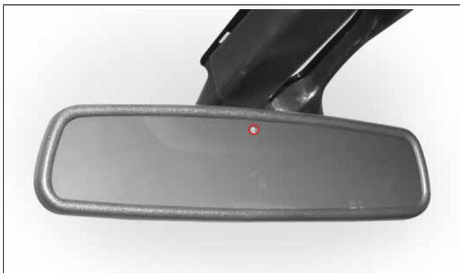
L'indice de réflexion du rétroviseur intérieur peut être réglé automatiquement par l'intensité lumineuse des projecteurs d'un véhicule qui vous suit.
