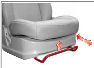
Pour déplacer le siège vers l'avant ou l'arrière, levez le levier de glissière de siège et déplacez le siège selon les besoins. Ensuite, relâchez le levier à la position désirée.
