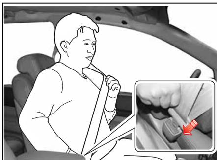
2. Faites passer la sangle baudrier sur le buste et la sangle abdominale le plus bas possible près des hanches. Insérez la plaque de verrouillage dans la boucle jusqu'au déclic.
