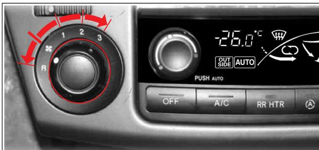
3. Quand le commutateur de climatisation arrière occupe la position "R", il peut commander la vitesse du ventilateur.
