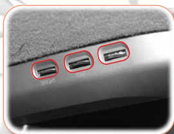
Pour régler le moniteur, utilisez la commande à trois positions placée du côté gauche de la base du moniteur.
