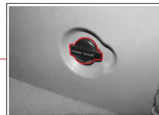
Cette prise de courant se découvre sur le côté droit de la paroi de la carrosserie quand le siège de quatrième rangée est relevé. Pour les mises en garde et avertissements détaillés, référez-vous au chapitre Prise de courant avant.
