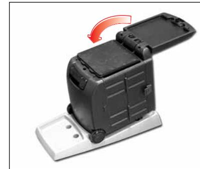
En faisant pivoter le couvercle intérieur du couvercle de la console centrale, il peut servir de tablette aux sièges avant.
