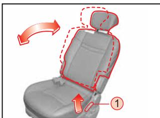
Pour modifier l'angle du dossier de siège, penchez-vous légèrement vers l'avant et levez le levier. Ensuite, penchez-vous vers l'arrière à l'angle du levier et relâchez le levier. Ce levier est conçu pour régler le dossier du siège jusqu'à un certain angle.
