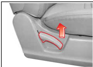
Pour modifier l'angle du dossier de siège, penchez-vous légèrement en avant et levez le levier. Ensuite, penchez-vous vers l'arrière à l'angle du levier et relâchez le levier. Après le réglage, le levier doit retourner à son emplacement d'origine et le dossier de siège doit être verrouillé.
