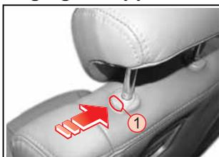
Pour lever l'appui-tête, tirez vers le haut sans appuyer sur le bouton de déverrouillage. Pour abaisser l'appui-tête, pressez le bouton de déverrouillage ① placé au sommet du dossier du siège et poussez l'appui-tête, vers le bas.
