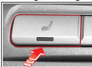
Pressez le bouton pour chauffer le siège et pressez-le à nouveau pour arrêter le chauffage.
