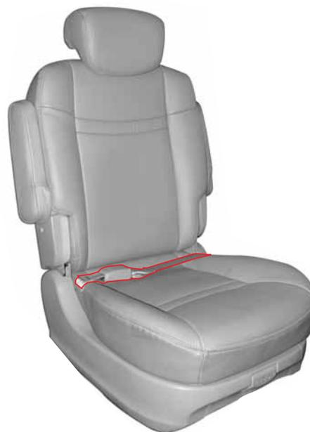
La ceinture se place à travers le bassin. La ceinture est assujettie en deux points de la carrosserie et du siège.
