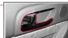
Les leviers d'ouverture des portes arrière des côtés droit et gauche possèdent les mêmes fonctions que ceux de la porte du conducteur. Cependant, le bouton de verrouillage/déverrouillage commande uniquement la porte concernée.
