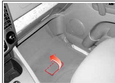
Le numéro du châssis est estampillé sur le plancher, sous la moquette du côté passager.
