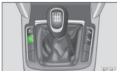
Fig. 172 Touche de réglage de la valeur de contrôle pour la pression des pneus
