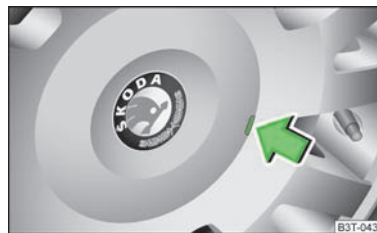
Fig. 171 Retrait de l'enjoliveur sur les roues en alliage léger
