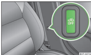
Fig. 14 Touche pour la surveillance de l'habitacle et la surveillance de la protection anti-remorquage
