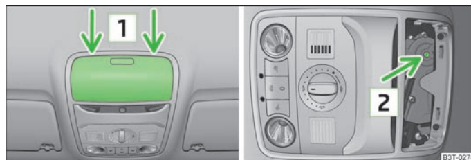
Fig. 28 Décoque du ciel de pavillon/point d'application de la clé
