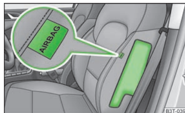
Fig. 145 Emplacement des airbags latéraux dans le siège du conducteur
