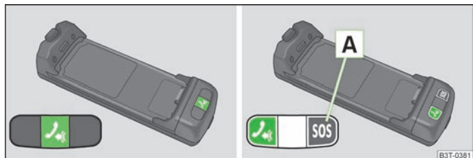
Fig. 131 Schéma du principe : Adaptateur à une touche/adaptateur à deux touches
