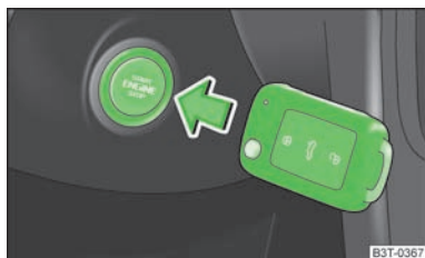
Fig. 115 Démarrage d'urgence du moteur
