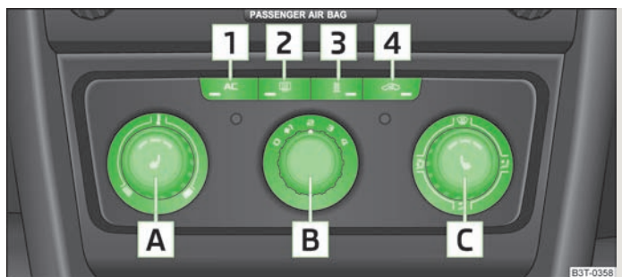
Fig. 108 Climatiseur : organes de commande
