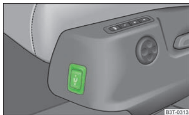
Fig. 58 Touche à bascule de la ventilation des sièges
