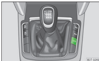
Fig. 23 Commande du capot - touche dans la console centrale
