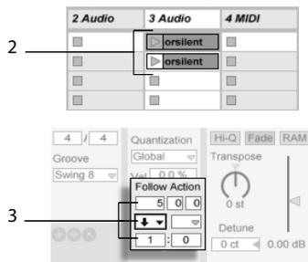
3. Etablissez les Actions Suivantes pour le premier clip. Vous choisirez l'instant de déclenchement de l'Action Suivante pour qu'il corresponde à la longueur du clip. Réglez le sélecteur d'Action Suivante A sur "Jouer Clip suivant", avec un réglage Chance de 1, en laissant tranquille l'Action Suivante B. A présent, ce clip est configuré pour passer au clip bouclé une fois reproduit.
