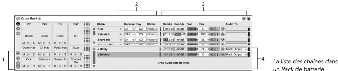
1. En plus des sélecteurs standard présents dans tous les Racks, les Racks de batterie ont quatre commandes supplémentaires en colonne d'affichage. De haut en bas, ce sont le bouton Auto-sélection et les commutateurs d'affichage des sections d'entrée/sortie (I-O), de départ (S pour Send), et de retour (R).
