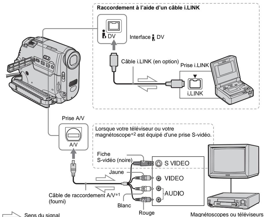
\*1 Le câble de raccordement A/V fourni est doté d'une fiche vidéo et d'une fiche S-vidéo pour le raccordement vidéo.
