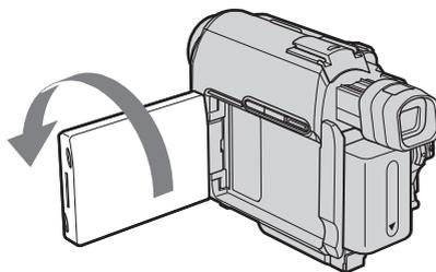
**Ouvrez le panneau LCD à 90 ° vers le caméscope, puis faites-le pivoter à 180 ° vers le sujet.**
