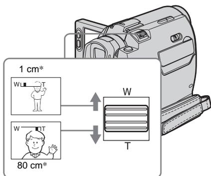
\* La distance minimale nécessaire entre votre caméscope et le sujet afin d'obtenir une mise au point nette, lorsque la manette est dans cette position.
