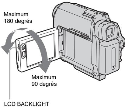
Ouvrez le panneau LCD à 90 ° vers le caméscope, puis faites-le pivoter vers la position souhaitée.
