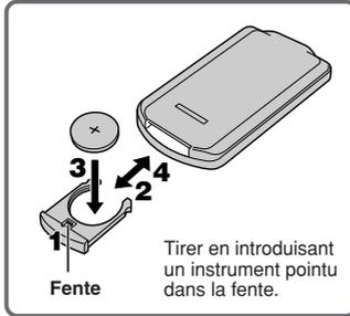
Tirer en introduisant un instrument pointu dans la fente.
