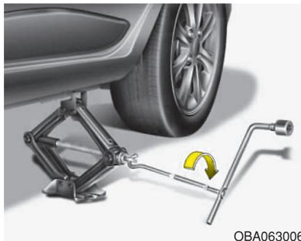
8. Insérez le levier du cric dans le cric et tournez-le dans le sens des aiguilles d'une montre, pour monter le véhicule juste assez pour que la roue quitte le sol. Soit approximativement 30 mm (1,2 in). Avant de retirer les écrous de la roue, assurez-vous que le véhicule est stable et qu'il n'y a pas de risque de mouvement ou de glissement.
