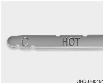
3. Confirmez que le niveau de liquide est situé dans la partie "HOT" de la jauge de niveau. Si le niveau de liquide est plus bas, ajoutez le liquide spécifié par l'orifice de remplissage. Si le niveau de liquide est plus haut, drainez le liquide par l'orifice de vidange.
