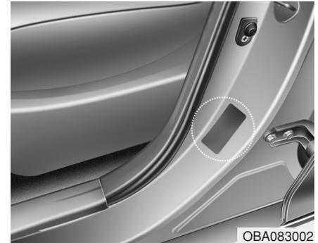
La vignette de certification du véhicule fixée au montant central côté conducteur (ou passager avant) comporte le numéro d'identification du véhicule (VIN).
