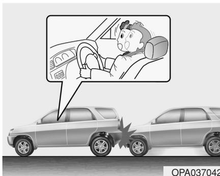
Les airbags frontaux ne sont pas conçus pour se gonfler en cas de collision arrière, car les passagers sont déportés vers l'arrière par la force de l'impact. Dans ce cas, des airbags gonflés ne sont pas en mesure de donner de protection supplémentaire.
