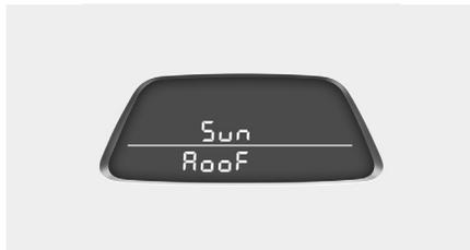
Si le conducteur retire la clé de contact (clé intelligente: coupe le moteur) et ouvre la porte côté conducteur lorsque le toit ouvrant n'est pas totalement fermé, l'avertissement sonore retentit et le voyant d'avertissement de toit ouvrant ouvert s'allume ou clignote.
