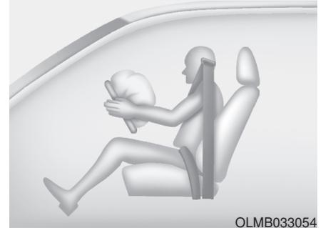
Quand le MCSRS détecte un impact suffisamment sérieux à l'avant du véhicule, il déploie automatiquement les airbags frontaux.
