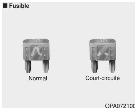
Le système GPL est protégé contre les courts-circuits/surcharges en utilisant un fusible (10A) installé dans le tableau de fusibles du compartiment moteur.
