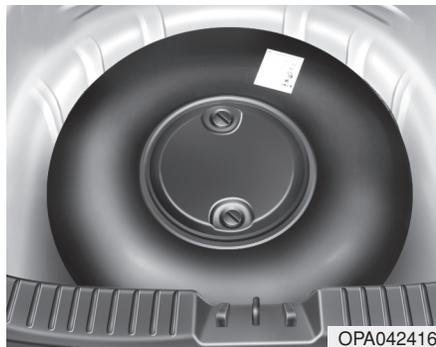
Le réservoir de GPL se trouve dans le coffre de votre véhicule (sous le tapis de coffre). Le réservoir de GPL a une forme toroïdale pour une meilleure disposition. Les étapes suivantes doivent être suivies pour chaque réservoir de GPL:
