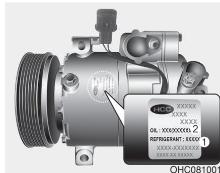
L'étiquette du compresseur vous informe du type de compresseur dont votre véhicule est équipé, ainsi que le modèle, le numéro de pièce du fournisseur, le code de production, le liquide frigorigène (1) et l'huile frigorigène (2).
