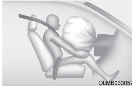
Après gonflage complet, l'airbag commence immédiatement à se dégonfler, permettant au conducteur de conserver la visibilité vers l'avant et de lui permettre de manœuvrer le volant ou d'activer d'autres commandes.
