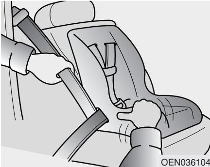
3. Retirer autant que possible le mou de la ceinture en poussant vers le bas sur le système de dispositif de retenue pour enfants tout en réintroduisant la sangle diagonale dans l'enrouleur.
