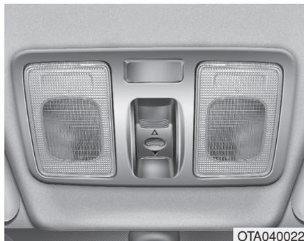
Si votre véhicule est équipé d'un toit ouvrant, vous pouvez coulisser ou incliner votre toit ouvrant avec le levier de commande du toit ouvrant situés sur la console de plafond.
